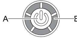
Drücken Sie die Taste (A) am Akku. Die LEDs (B) leuchten für ca. 10 Sekunden und zeigen den Ladezustand des Akkus an.
