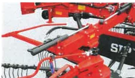
Hydraulische Schwadbreitenverstellung (serienmäßig bei STAR 850|26 T, 1000|30 T)
