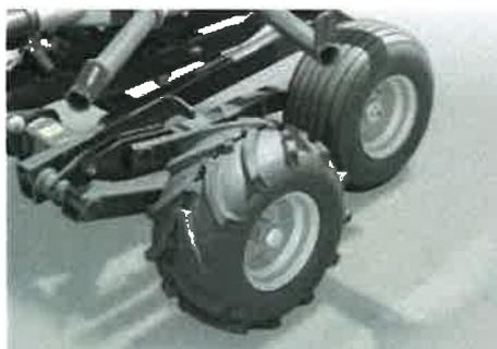
Rad mit Traktorprofil (erhältlich für STAR 430|12 T, 600|20 T)
